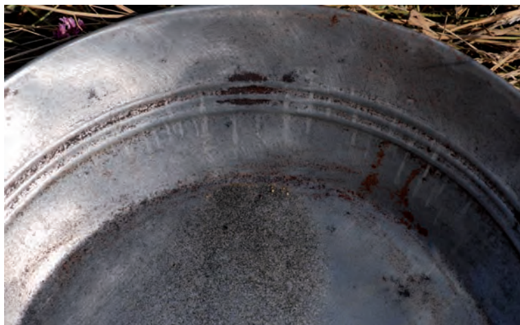
Fig. 8. Concentrado aurífero, segullum o segutilum , procedente del bateo en la zona de Pino del Oro
